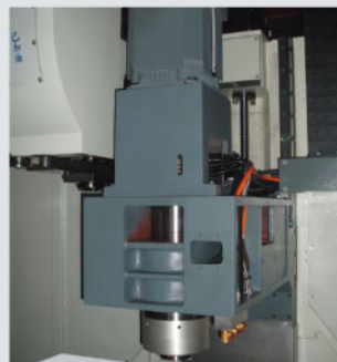
直結式主軸 (選配) 主軸轉速：12000轉 / 15000轉 Direct drive spindle (Opt.) Spindle speed: 12000 rpm / 15000 rpm
